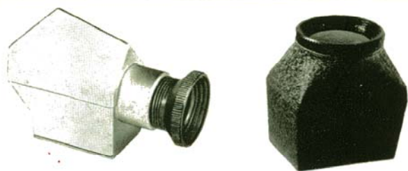
Til højre: Den otte gange forstørrende lup virker som en lysskakt, der holder falsk lys borte fra matskiven på alle sider. – Til venstre: Pentaprisme (seks gange). Begge hjælpemidler kan skydes på i stedet for rammesøgeren (Lysskakt og samtidig gennemsigtsøger med lysramme)
